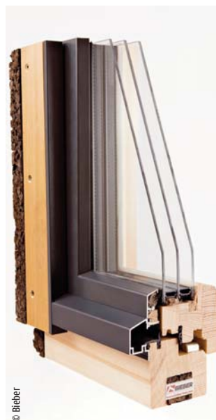
Cette fenêtre de Bieber a été mise au point pour les maisons passives à ossature bois. De la laine de mouton et du liège participent à l'isolation.
